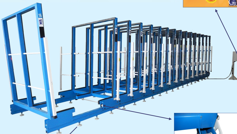
Movimento mecânico por sistema de cremalheiras.
