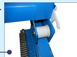
Movimento mecânico por sistema de cremalheiras.
